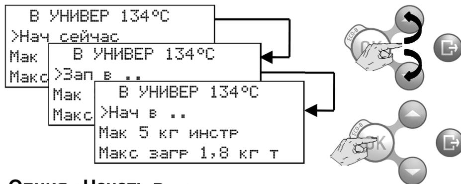
После выбора цикла программами кнопками ВВЕРХ и ВНИЗ прокрутите опции “начать сейчас”, “начать в...” и “начать через...”.
