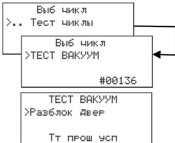
Кнопками ВВЕРХ, ВНИЗ и ОК прокрутите меню и выберите опции в следующем порядке: ЦИКЛЫ ИСПЫТАНИЯ – ВАКУУМНЫЙ ТЕСТ.
